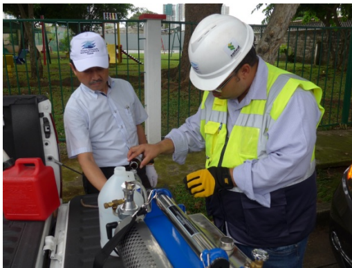
Operación de prueba del fumigador utilizando la mezcla de agua y glicerina
