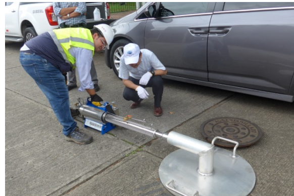
Operación de prueba del fumigador utilizando la mezcla de agua y glicerina
