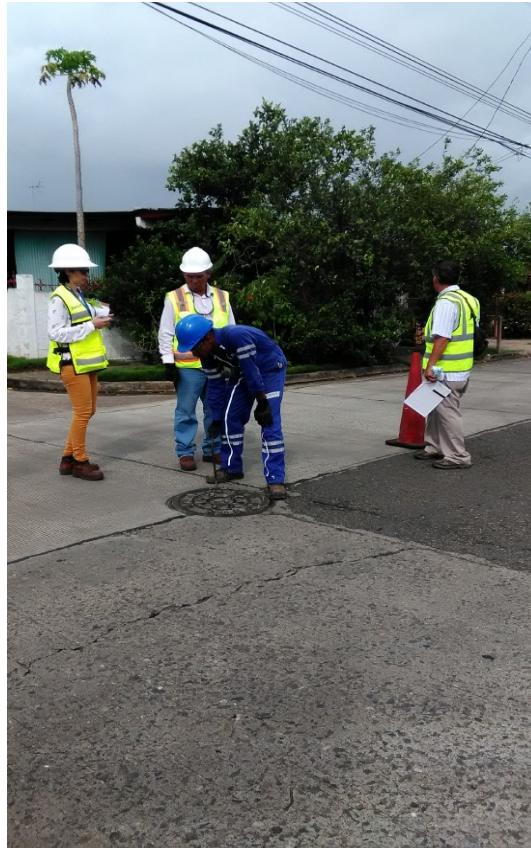
Estudio de infiltración de agua con medidor de EC (después de la toma de agua, está analizando en computadora)
