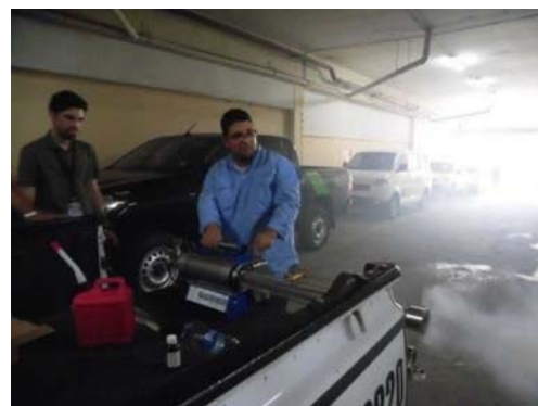
図 2.3.12 送煙調査用噴霧器使用方法の講習と発煙の状況の確認
