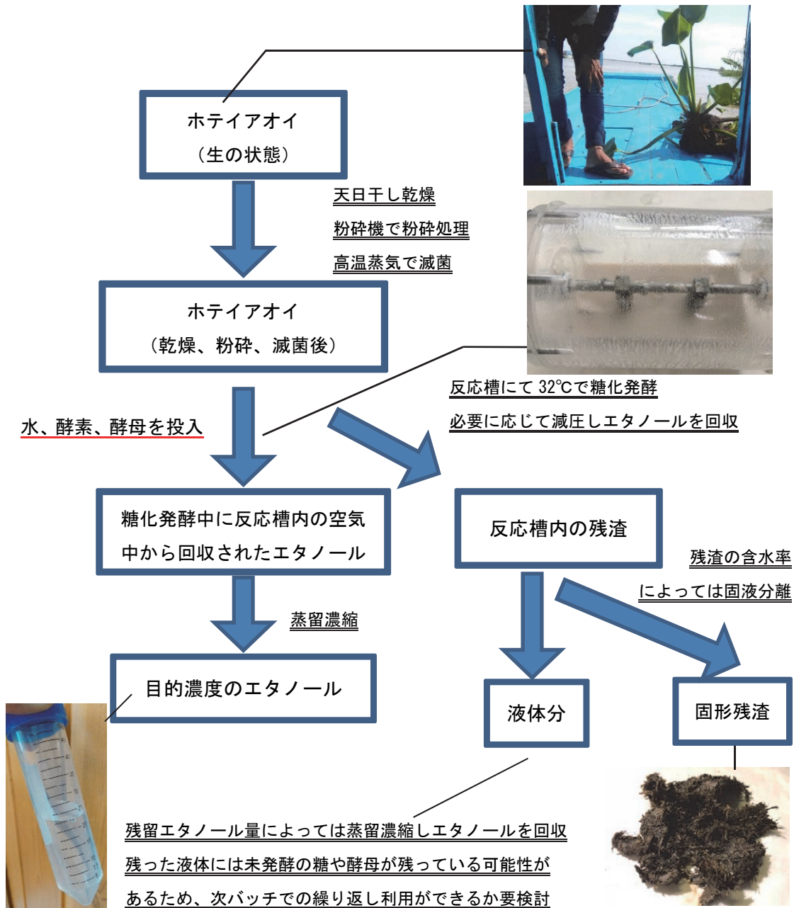
図 11 エタノール製造工程と関連する機材
