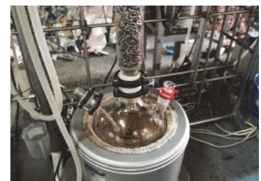
蒸留してエタノール製造
