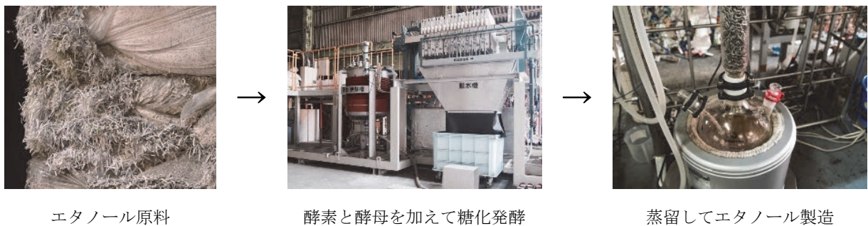
要約図 1 バイオエタノール製造工程
