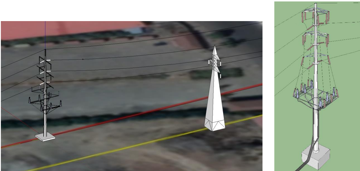
図 7.1-4 T67 のウエレガヌ変電所からのケーブル立上げ架地鉄塔のイメージ
