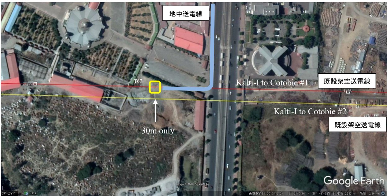
図 7.1-3 T67 のウエレガヌ付近の鉄塔配置(案)
