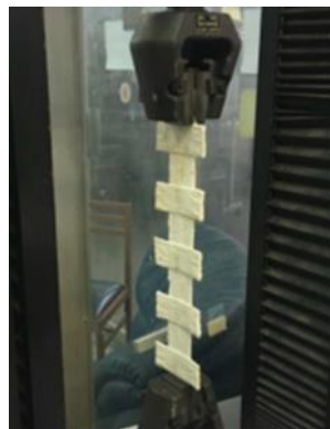
図 7 5 ガラス繊維シートの張力試験
