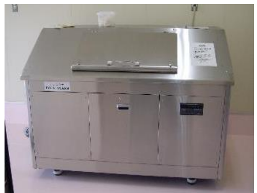
使用予定と同型の堆肥化装置
