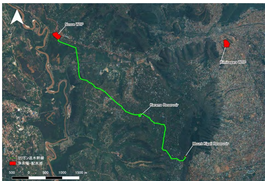
図 1-1 新ンゾベ1 プロジェクトで建設する送水管及び配水池
