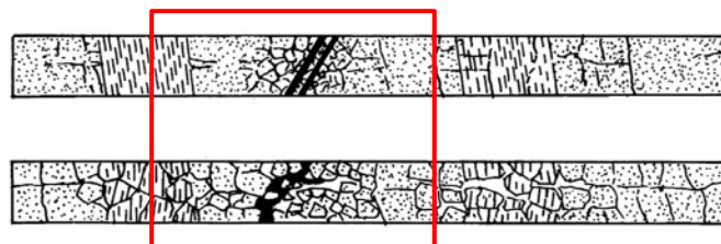
図2-4 ハイブリッド工法(上)と通常工法(下)によるコア品質比較イメージ
