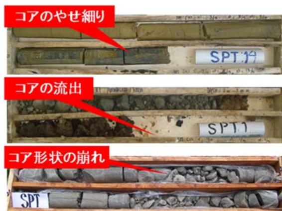
図1-1 インドネシアのコア品質(通常工法)
