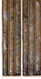
ハイブリッド工法による 地すべり地層のコア写真
