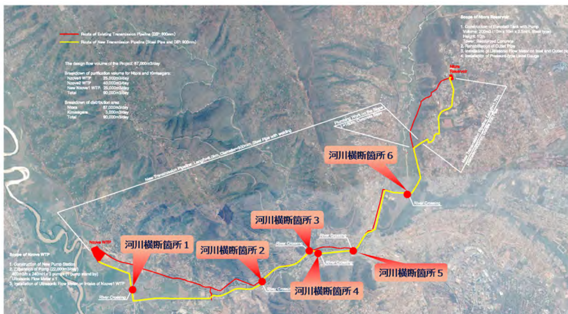
図 3-5 河川横断部での地盤調査地点
