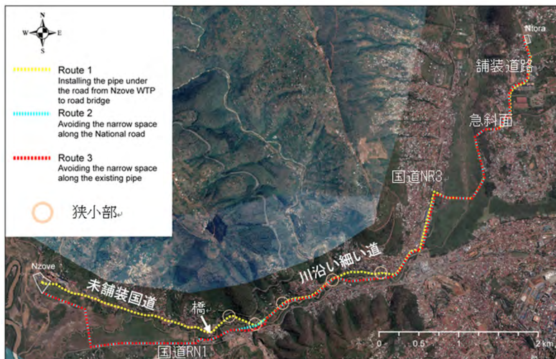
図 2-29 比較検討送水管設置ルート
