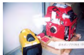
消火・排水ポンプ
