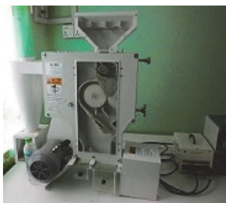
ラボに設置されたテスト精米機
