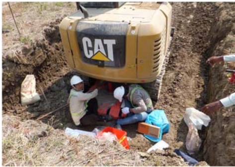
写真-2 平板載荷試験状況（この結果に基き極限支持力の算定式を提案）
