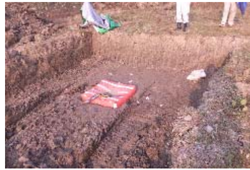
写真-2 平板載荷試験状況（この結果に基き極限支持力の算定式を提案）
