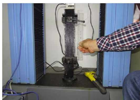
図 3-64 引張試験（緬国製 D・Box）
