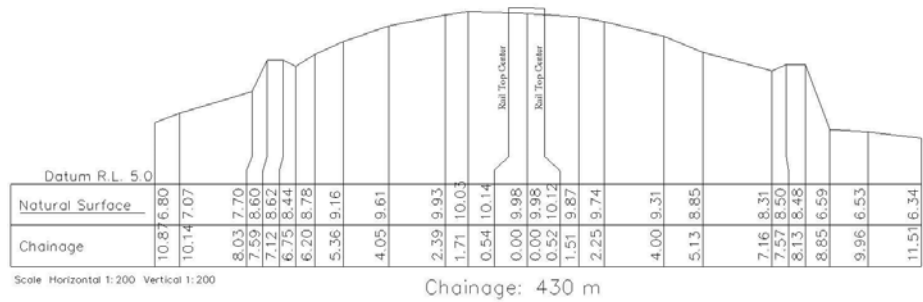
図 3-3 測量断面 CH430 の例
