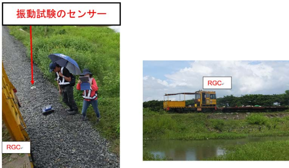
図 3-48 コンクリートブロックの上に置いたセンサー（左）と RGC(右) 出典：調査団撮影
