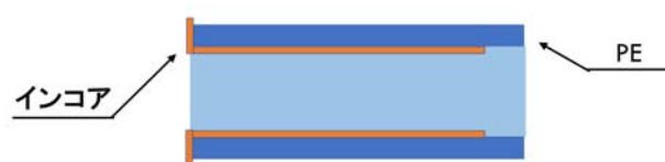
図 2-32 PE 管の変形を防ぐための金属製インコア
