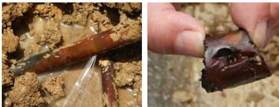
図 2-17 施工時の埋め戻し土中の突起物による破損が拡大した埋設管漏水孔
