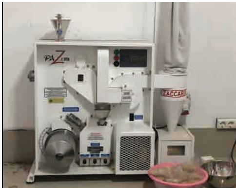
ICAPRD のサンプル米用の糊摺精米機
