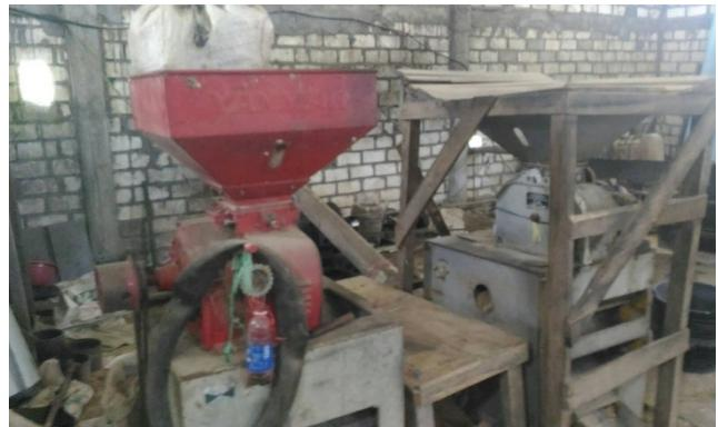
写真：使用されている精米機
