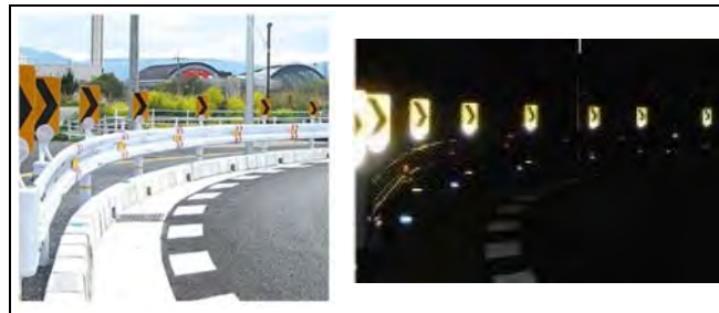
図 3-2-25 カーブの認識・逸脱対策
