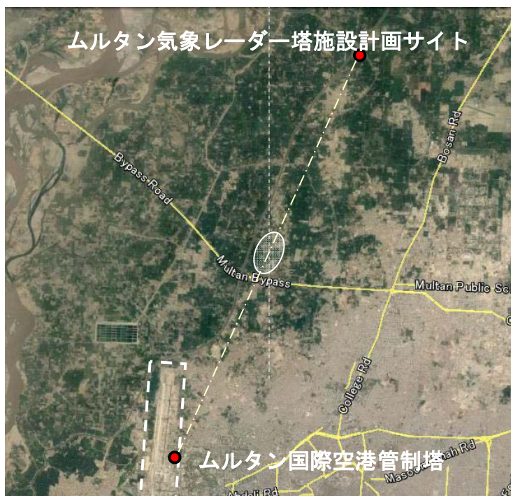
図 19 気象データ通信システムのフレネルゾーンと気象レーダービーム高さ
