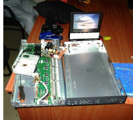
落雷により故障した通信機器
