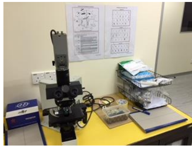
アスベスト含有検査を行うための顕微鏡及び計測ルールの掲示
