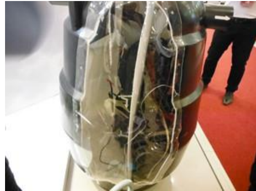
曝気装置と担体を追加した PE 製タンクのカットモデル
