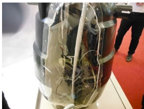
写真－6 PE 製タンクにエアポンプと担体を加えた小型のオンサイト処理施設
