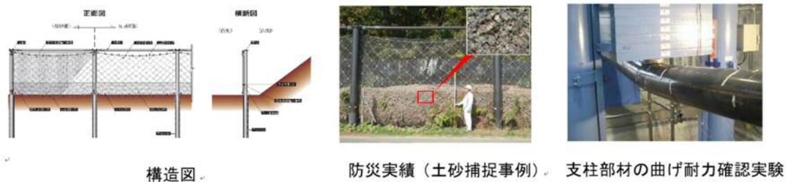
図 スロープガードフェンスの概要
