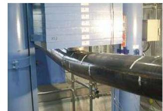
支柱部材の曲げ耐力確認実験
