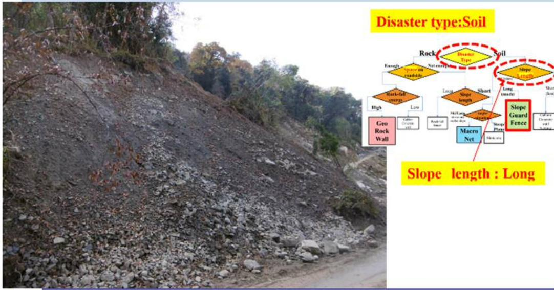
図6 スロープガードフェンスの適合性検討フロー
