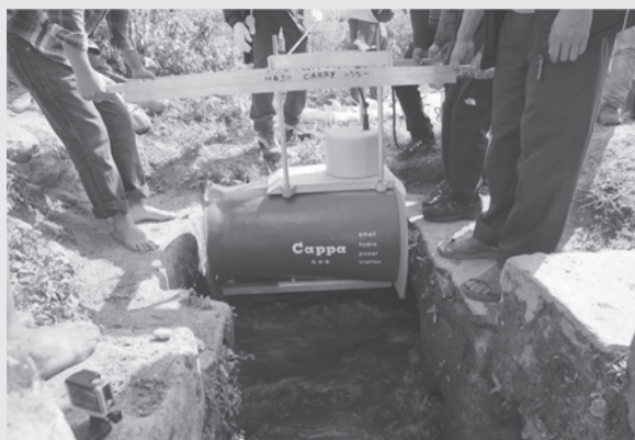
La pequeña generadora hidroeléctrica Cappa la pueden cargar dos adultos
