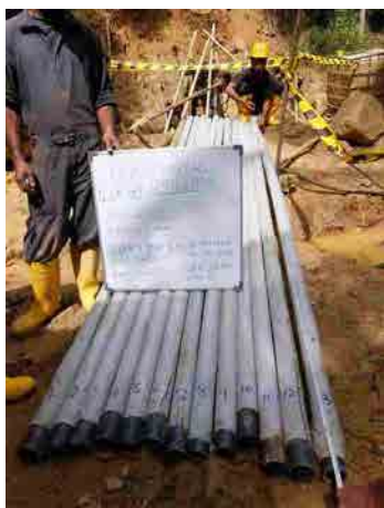
PVC pipes の材料検査 (4m/パイプ×13本=52m : 設計 50m)
