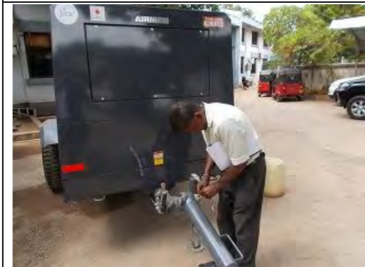
牽引部分の確認
