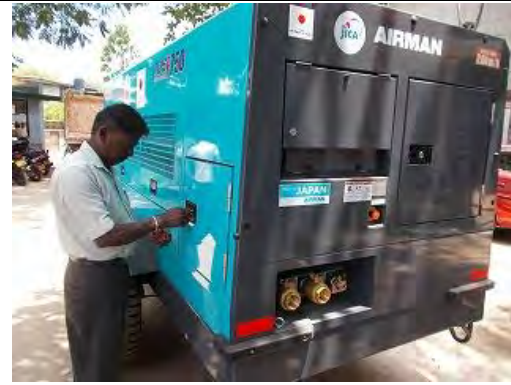
始業前点検（コンプレッサーオイル）
