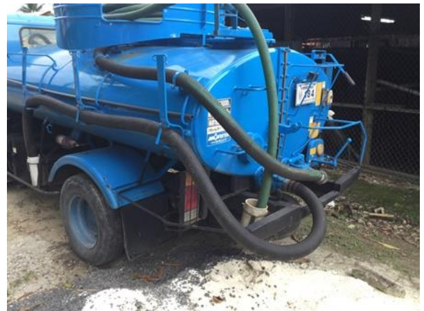
汚泥回収しているバキューム車
