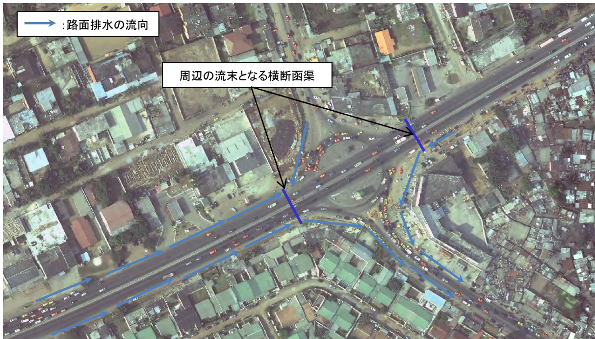
図 6.4.1 リビエラ3 交差点付近の路面排水方向
