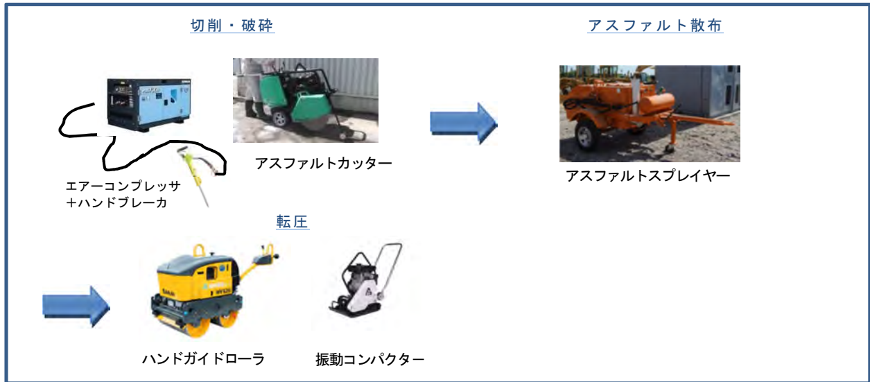
図 3-3 日常整備作業用の代表的機材
