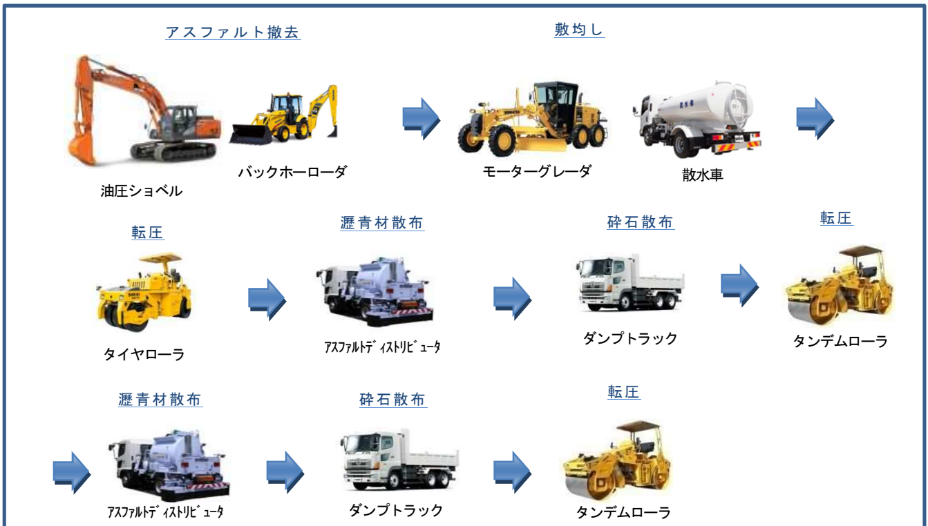
図 3-2 DBST 工法の代表的機材
