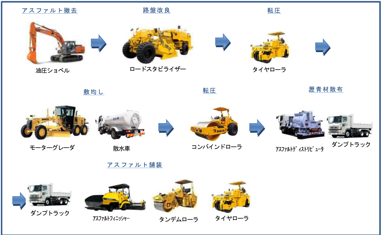
図 3-1 アスファルトフィニッシャー工法の代表的機材
