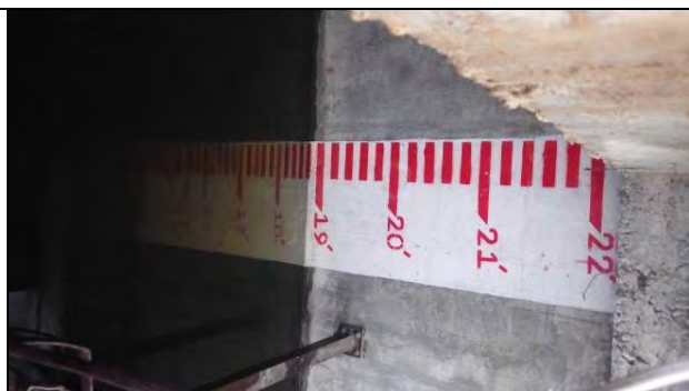
浄水池の水張試験 (2016年8月31日)
