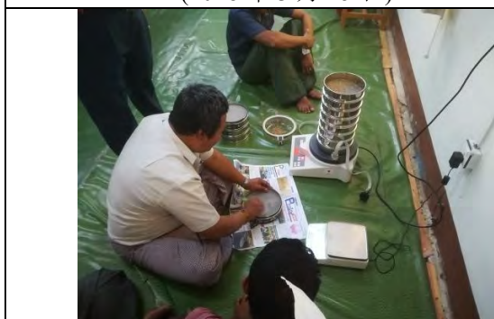
ろ過砂のふるい分け試験 (2018年3月16日)
