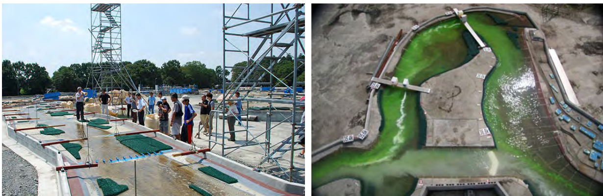
Figura 7.8 Ejemplos de los experimentos con un modelo de canal del agua (izquierda: modelo completo, derecha: ejemplo de rectificación del cauce)
