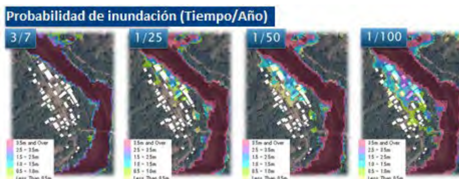
Figura 7-1 Ejemplo de producto de análisis de inundación con diferentes períodos de retorno
