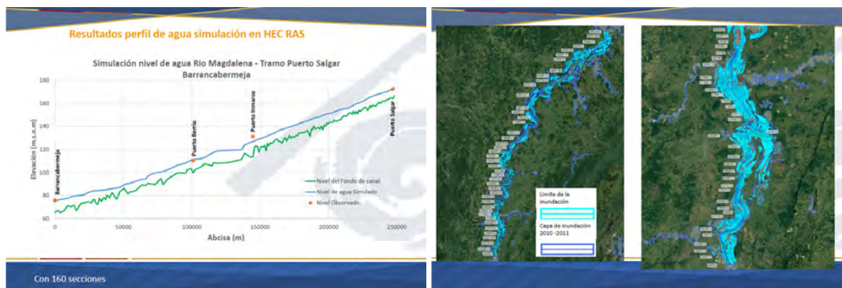
Figura 2.7 Comparación y estudio de la inundación real de 2010-2011 y el valor calculado
