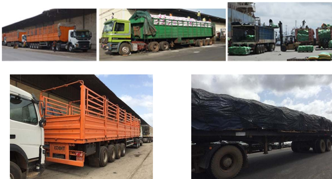
La longueur hors tout 18,5m Véhicule 4 axes : chargement de 65k / t
