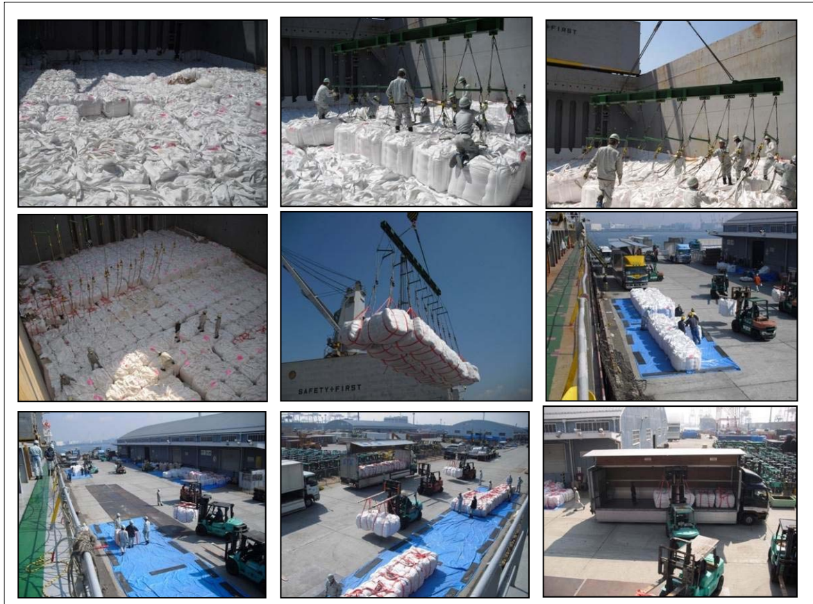
Figure 5.2.4-3 Méthode de manutention à l'aide de big bags
