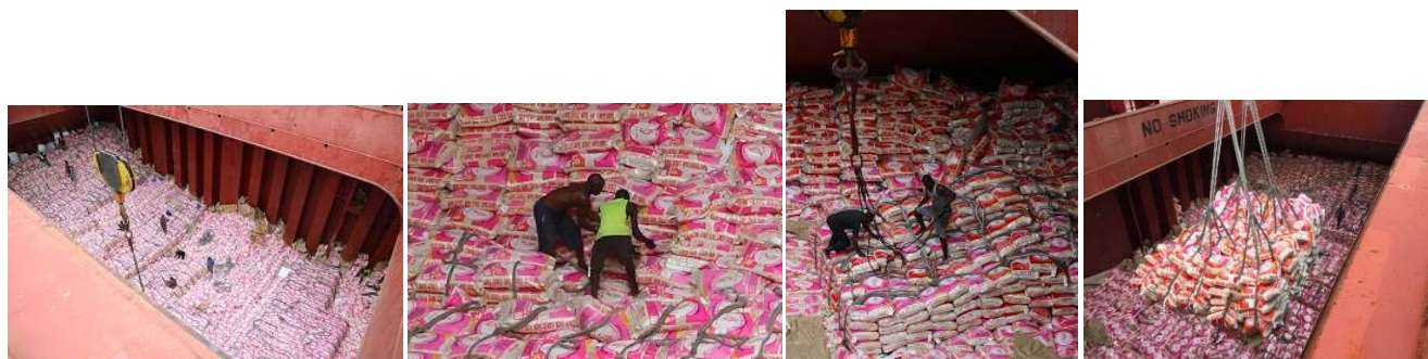
Figure 5.1.2-2 Travail de regroupement et de stabilisation des sacs de riz dans la cale
