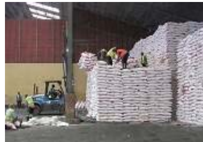
1 ou 2 regroupements d'un camion sont soulevés sur le tas de sacs de riz à l'aide d'un chariot-élevateur
