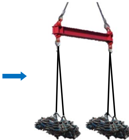
Figure 5.2.4.2 Méthode de manutention à l'aide d'une poutre de levage équipée de 2 crochets
