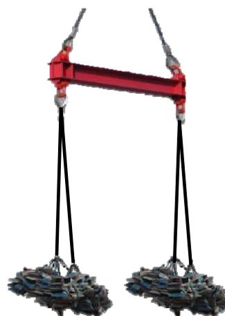
従来と同様の作業手順に特殊吊具を装着するだけで、2倍の効力が引き出せる即効性がある荷役能力向上の手段である。
