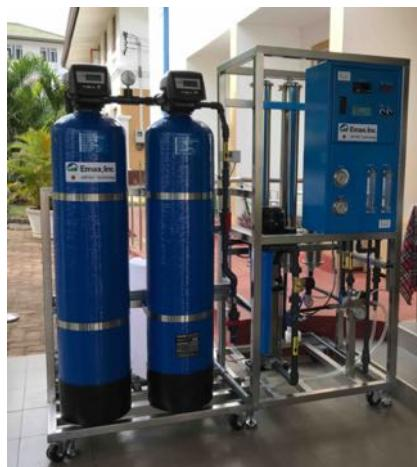
写真1 節水型 RO 膜浄水機
