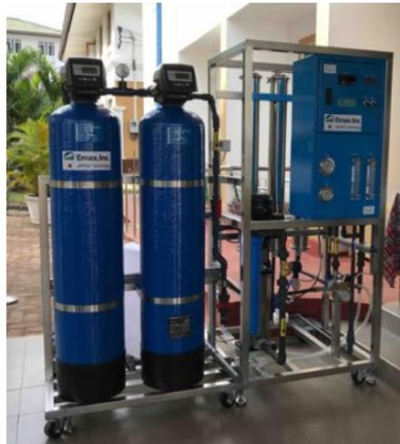
写真 8 節水型 RO 膜浄水機
