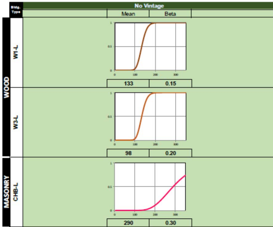
図 4-35 木造及び石積み造のための経験的手法による風の脆弱性カーブ
