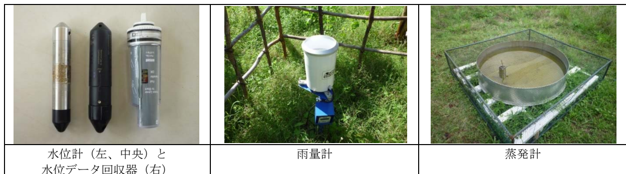
図 6.6.3 ため池水位、雨量、蒸発量の観測機器
