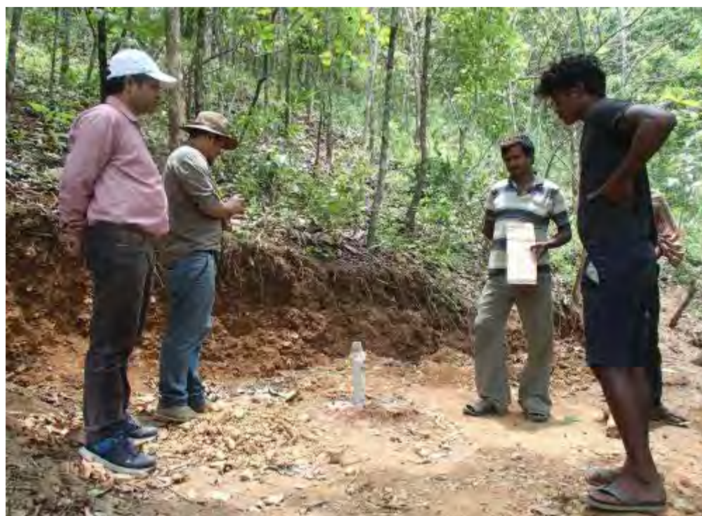
図 3.3-3 ボーリング調査 (水位観測孔の設置)
