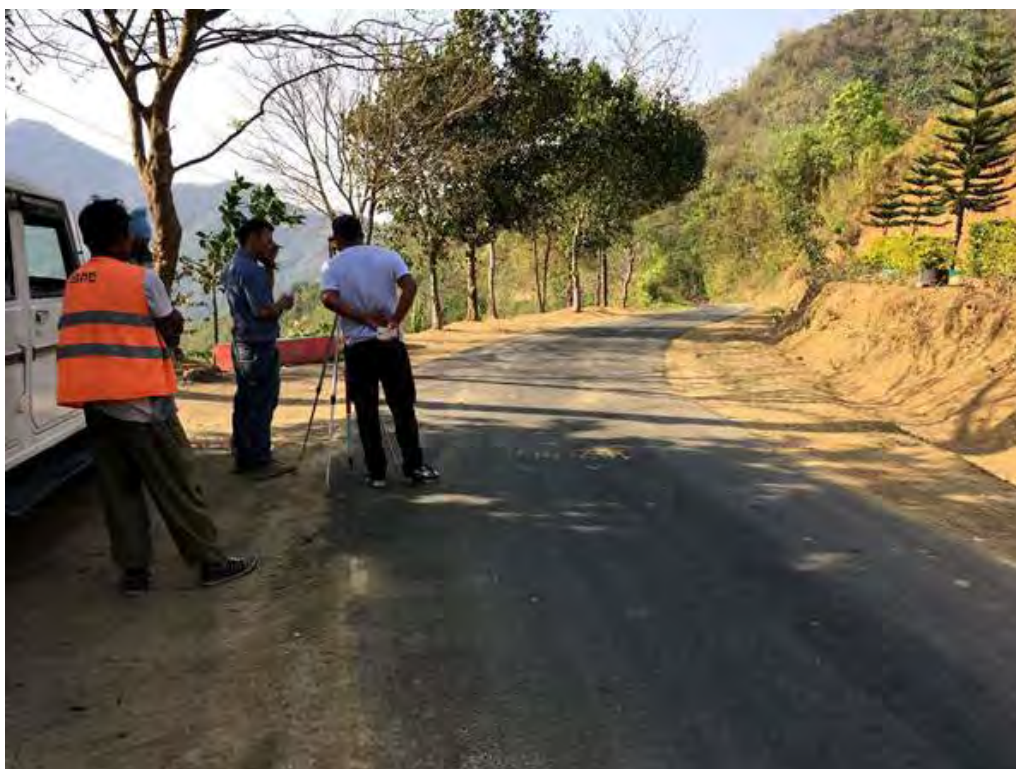
図 3.2-1 測量調査 (トラバース測量)
