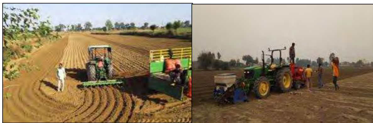
図 3-3 播種作業の写真（左）耕起作業の風景、（右）プランター（欧州の機械メーカー製）による播種作業（施肥、培度も同時に行う）
