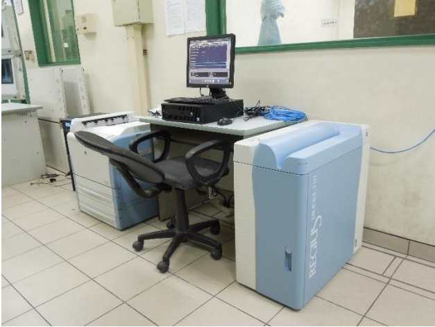
CR/DR システムコンソール、 CR リーダー、ドライイメージャ
