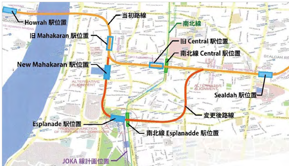
図 4.4.18 計画変更による駅位置の変更概念図
