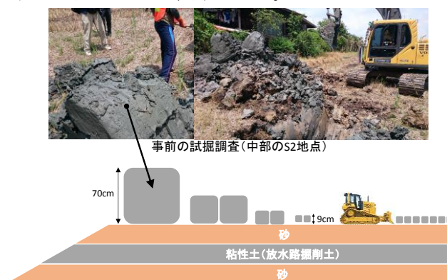
図 7.9.11 粘性土と砂を交互に積み上げるストックパイル
