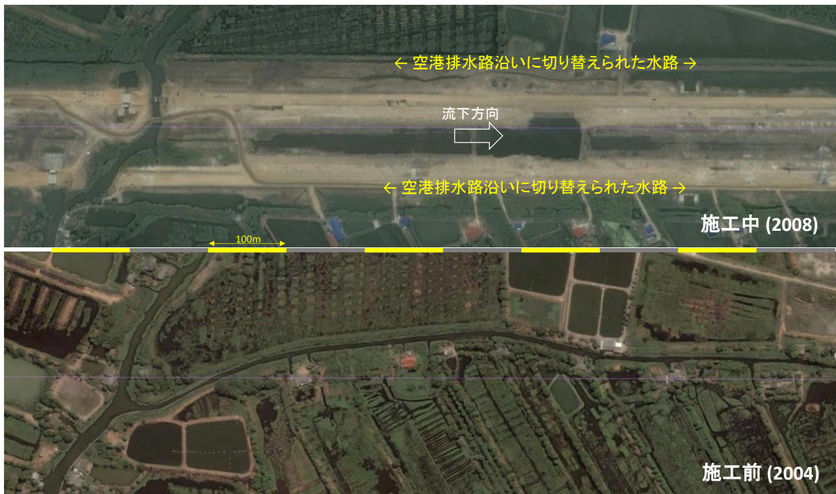
図 7.9.5 スワナプーム空港排水路施工時の既存灌漑水路切替状況
