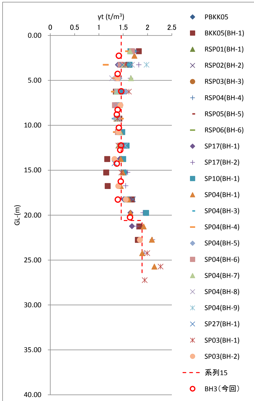
図 4.3.23 既往ボーリング及び本検討で実施したボーリングから設定した単位体積重量
