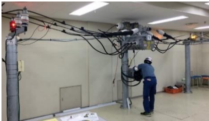
図 3-3 東京電力 PG における訓練設備および配電系統制御システム
