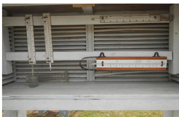
気象観測所百葉箱内の気温測定のための水銀計およびアルコール計
