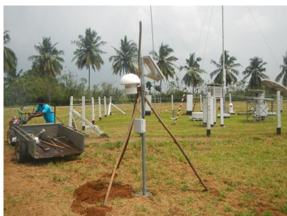
既存の観測装置に隣接して設置した気温データ自動収集装置
