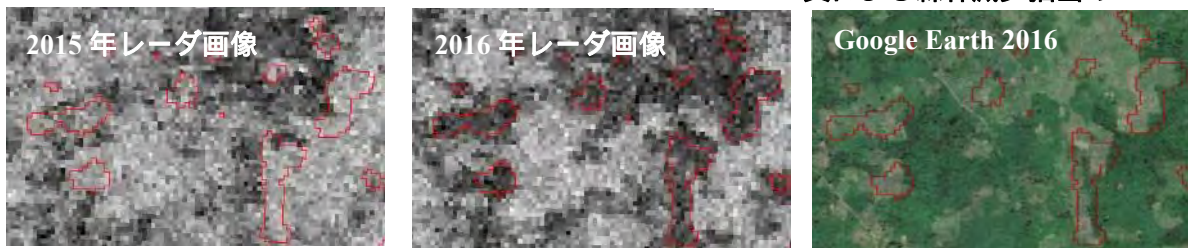
図 3.7 閾値を用いて抽出された森林減少エリア（赤ポリゴンのエリア）の例
