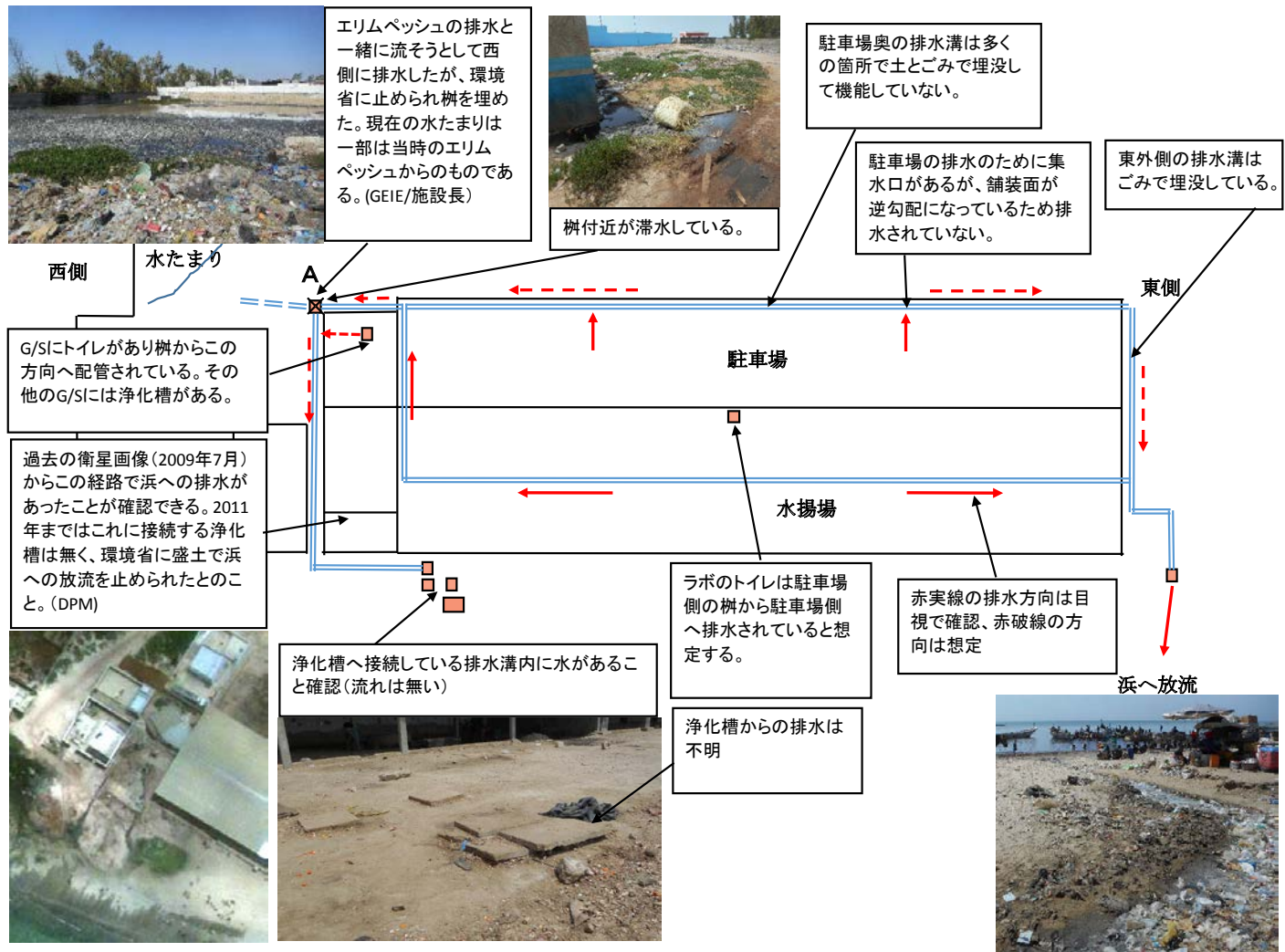
図 2-8 ジョアール既存施設排水の状況
