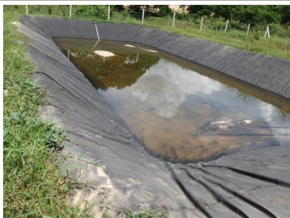
比較性能試験ため池(シートのみ)
