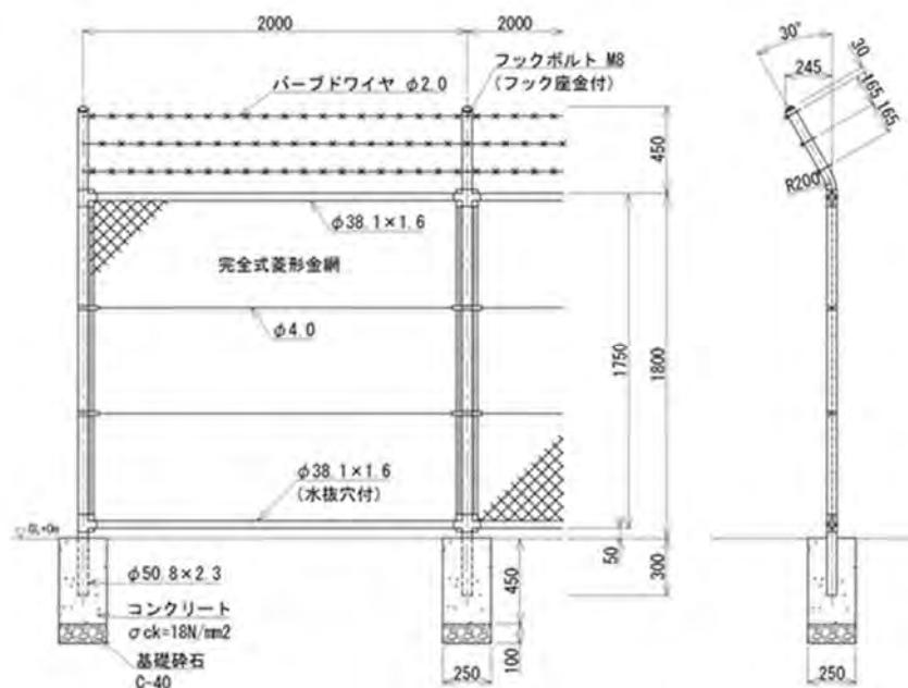
図3.33 飛散防止用フェンス参考図
