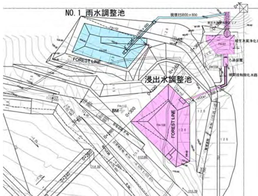
図 3.20 浸出水調整池越流水と No.1 雨水調整池放流水の位置関係
