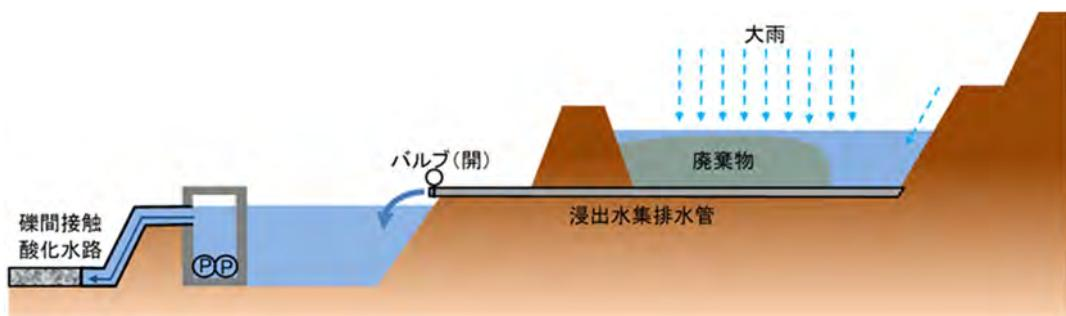
図 3.14 大雨時の浸出水の状況
