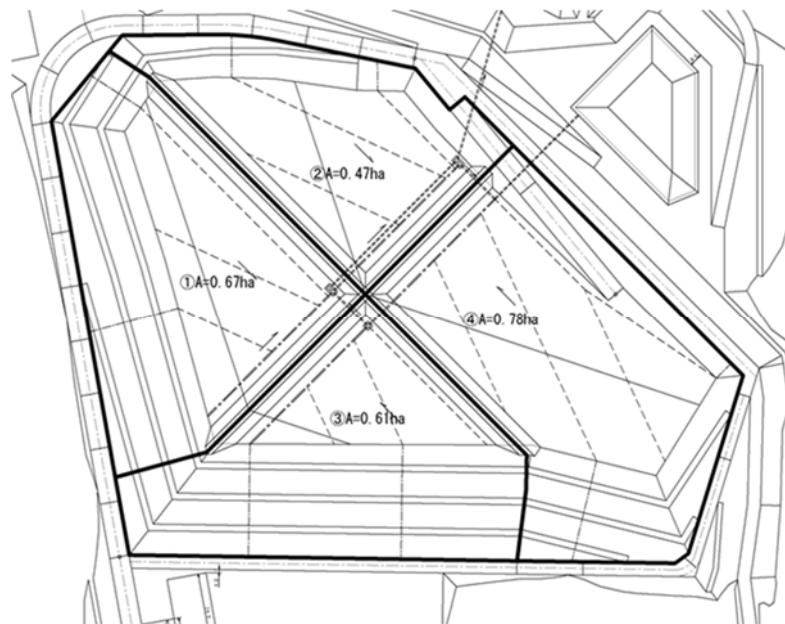
図 3.23 浸出水集排水管（幹線）流域図
