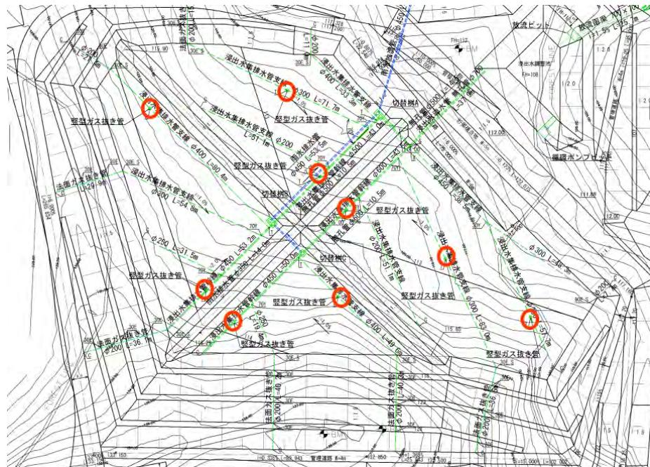
図 3.55 竪型ガス抜き管位置図
