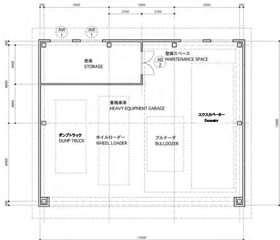
図 3.28 重機車庫平面図
