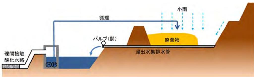
図 3.12 浸出水の埋立地への返送
