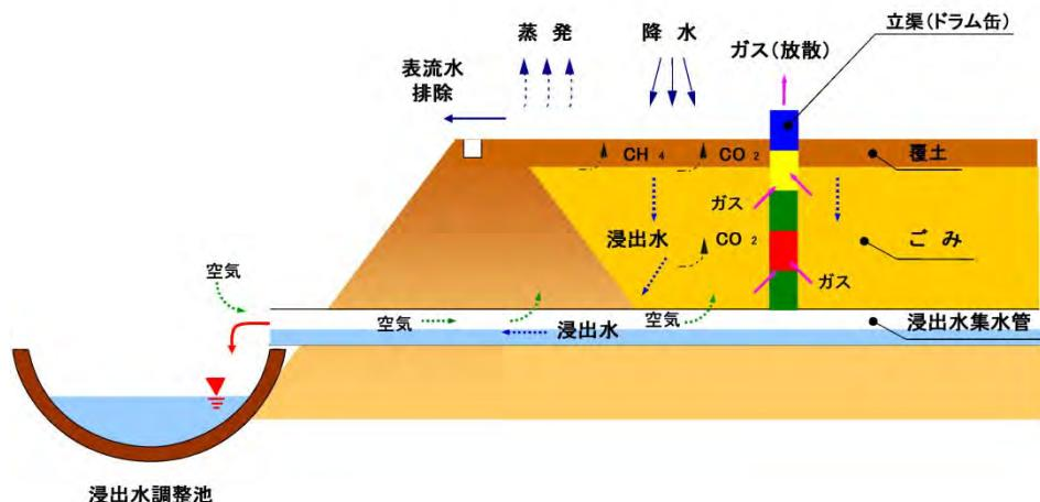
図 3.1 準好気性埋立構造イメージ
