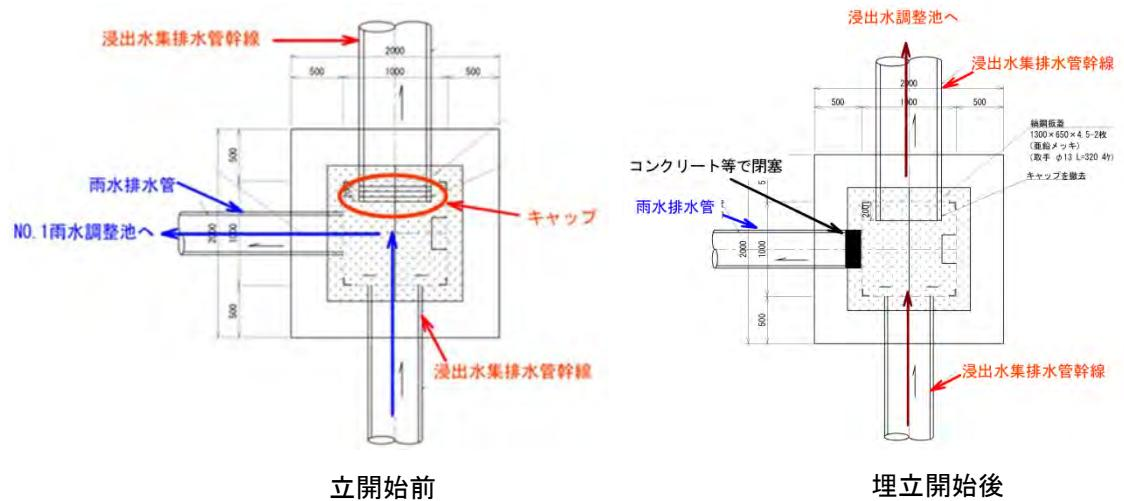
図3.22 切替弁構造図
