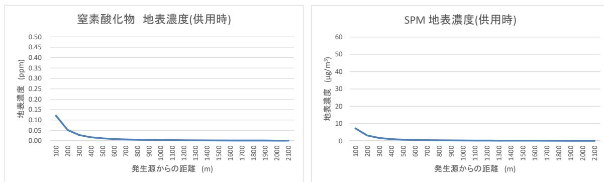
図 2.18 供用時の大気質(窒素酸化物および SPM)の予測結果
