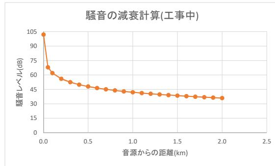
図 2.21 工事中の騒音の距離減衰予測結果
