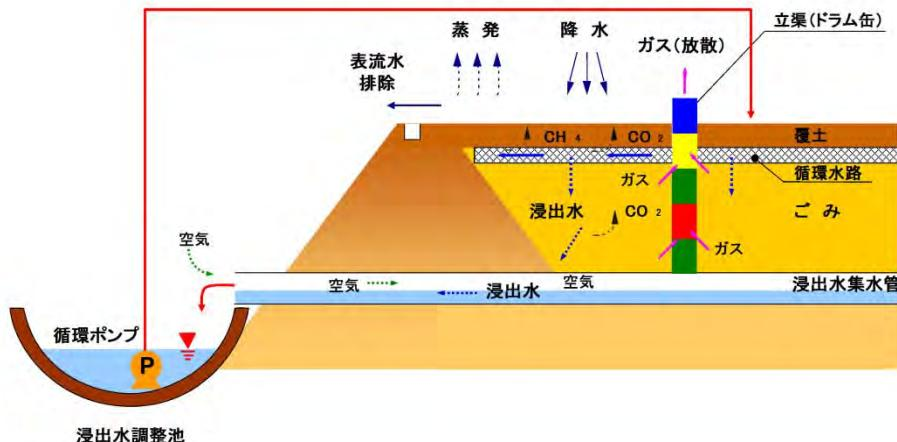
図3.2 循環式準好気性埋立構造イメージ
