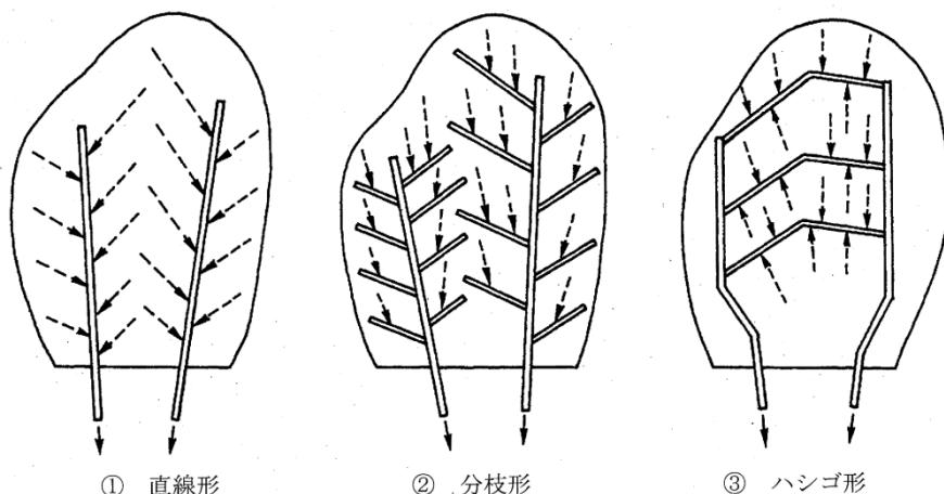
図 3.21 埋立地底面部浸出水集排水管の配置型式例
