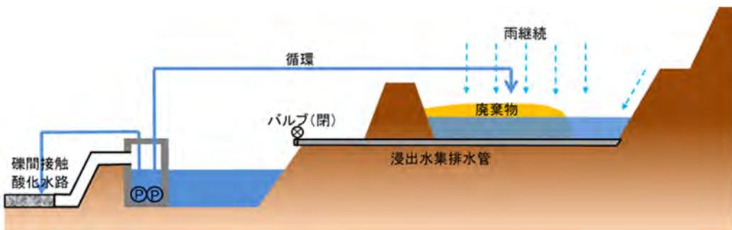
図 3.13 浸出水の埋立地への貯留
