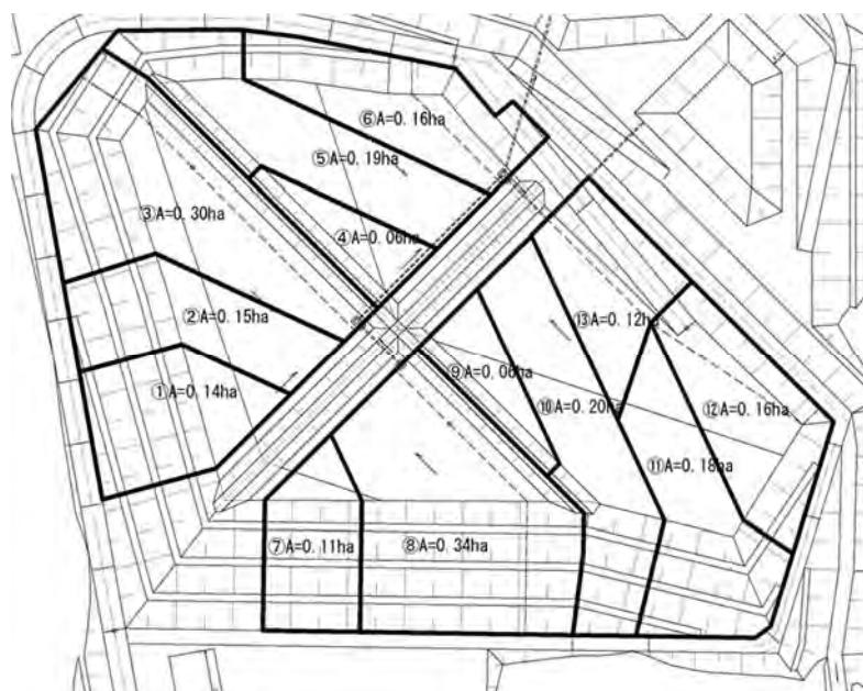
図 3.24 浸出水集排水管（支線）流域図
