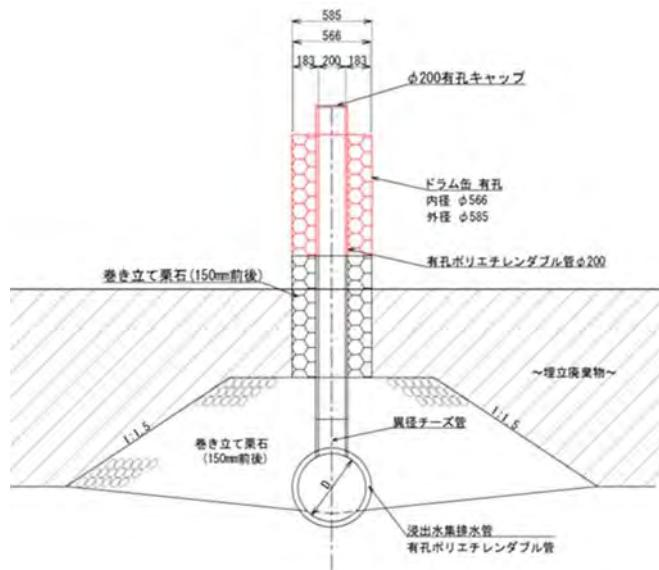
図 3.56 堅型ガス抜き管断面図
