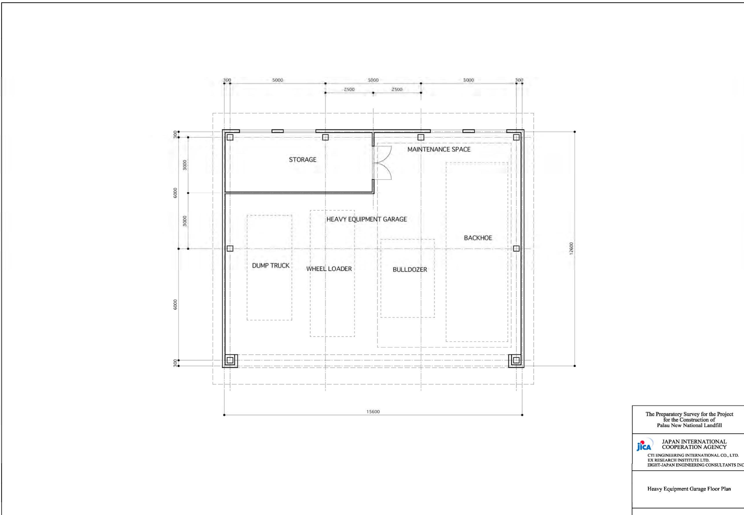
図 3.42 重機車庫平面図
