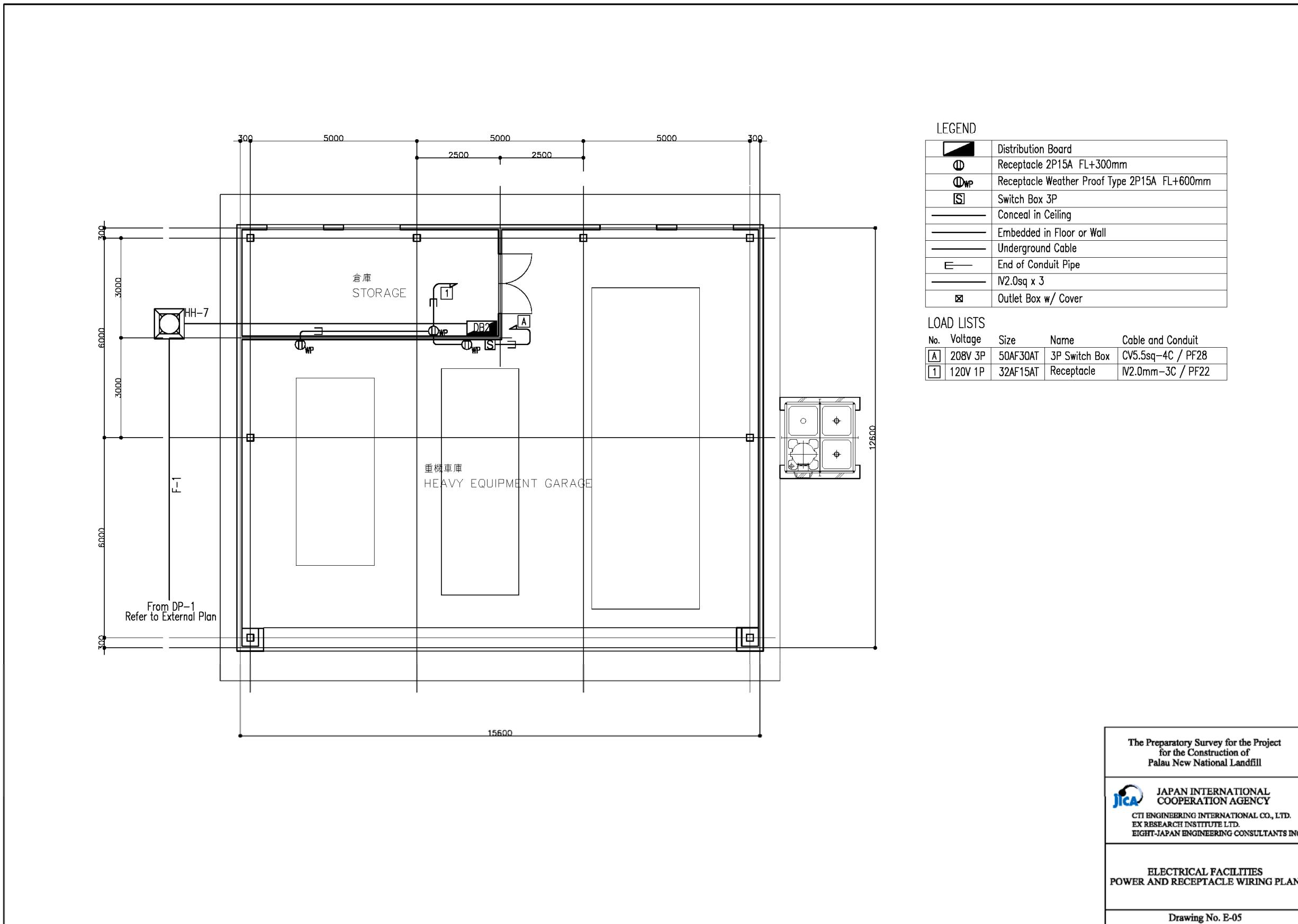
図 3.49 重機車庫動力図
