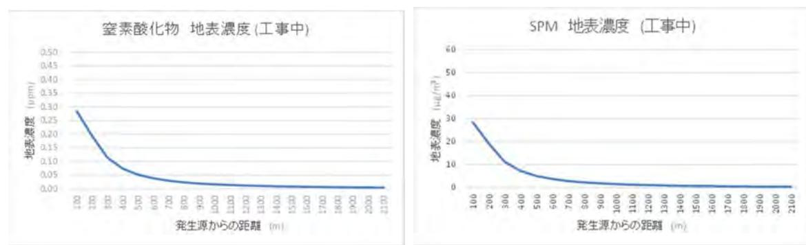
図 2.17 工事中の大気質(窒素酸化物および SPM)の予測結果
