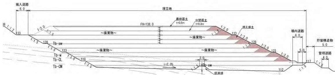
図 3.54 埋立完了縦断図
