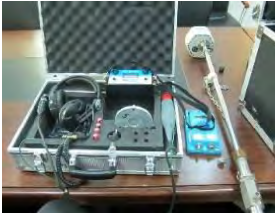
Leak Detector and EM Flow meter
